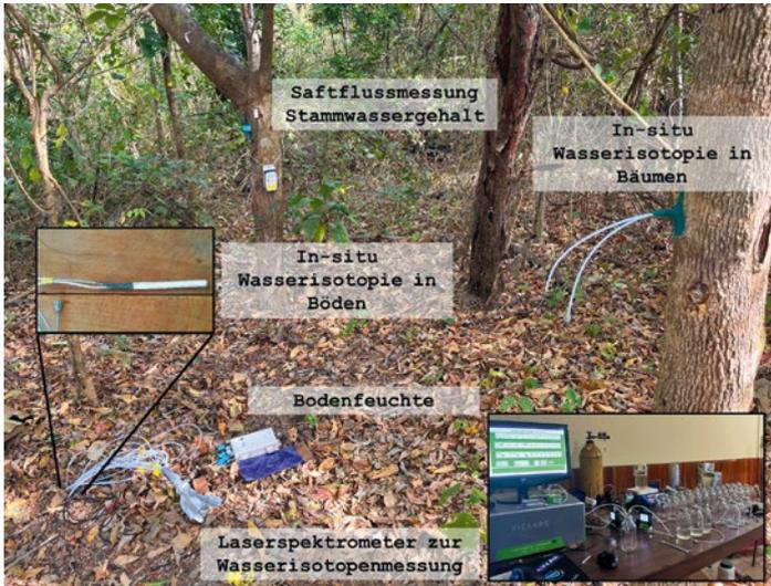
Typischer Versuchsaufbau im Feld: Wasserflüsse aus dem Boden und aus Baumstämmen werden gemessen und mit einem Wasserisotopen-Monitoring kombiniert, um die Anteile verschiedener Bodenwasserquellen an der Transpiration kontinuierlich zu quantifizieren.
